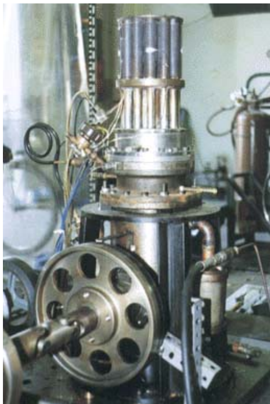
2 kW級実験用スターリングエンジン（船舶技術研究所）
